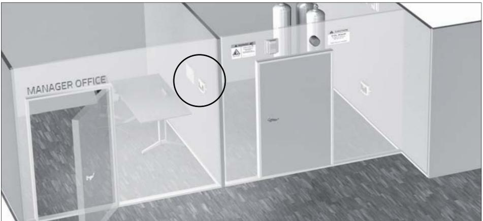
1. Si votre ensemble inclut une unité centrale, elle doit être installée à l'extérieur de la zone ou de la pièce surveillée, par exemple sur une paroi du bureau du directeur. L'unité centrale doit être installée à une hauteur clairement visible et accessible.
