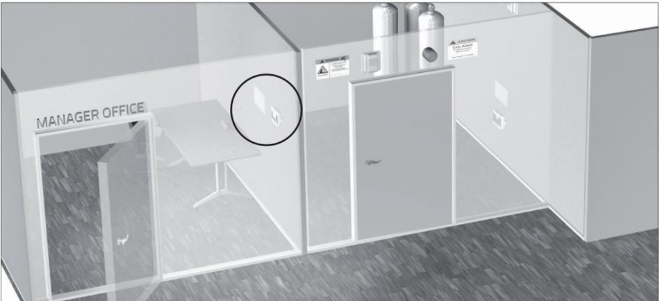
1. Se o seu conjunto incluir uma unidade central, ela deve ser instalada fora da área ou da sala que está a ser monitorizadas, por exemplo, numa parede no escritório dos responsáveis. A unidade central deve ser instalada a uma altura claramente visível e alcançável.
