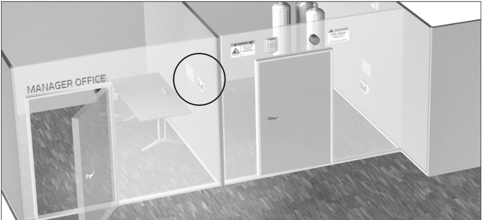
1. Si votre ensemble comprend une unité centrale, celle-ci doit être installée en dehors de la zone ou de la pièce surveillée, par exemple sur un mur du bureau du responsable. L'unité centrale doit être installée à une hauteur clairement visible et accessible.
