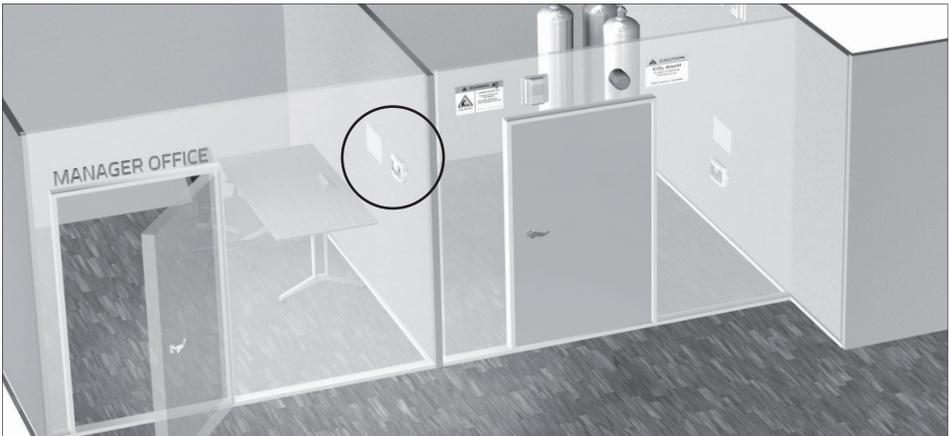
1. Si su conjunto incluye una unidad central, debe instalarla fuera del área o la sala monitorizadas, por ejemplo en una pared de la oficina del encargado. La unidad central debe instalarse a una altura claramente visible y accesible.
