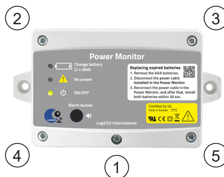
Fig. 4, Si es necesario retirar la cubierta del Monitor de potencia, siga el siguiente orden para volver a montar los tornillos.
