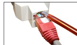
Verwenden Sie einen kleinen Schraubendreher, um die RJ45-Stecker zu trennen.
