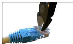
Schneiden Sie die Verlängerung der Rastnase an den RJ45-Steckern ab, um ein unbefugtes Trennen des O<sub>2</sub>-Sicherheitssystems zu verhindern.
