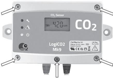
2. Aplique el gas cero con la herramienta de inyección de gas hasta que el valor en la pantalla se haya estabilizado. Esto tarda normalmente 1-2 minutos. Tenga en cuenta que debe utilizar un flujo bajo de gas. Siga aplicando el gas durante todo el procedimiento de calibración.
